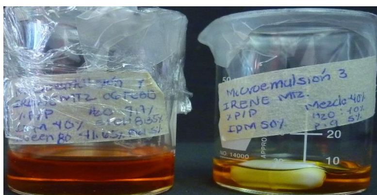
Figura 23. Microemulsiones con ranitidina HCl. Después de una semana se observó cambio de color de amarillo a anaranjado.
