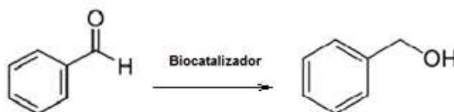
Figura 15. Reacción de reducción biocatalizada de benzaldehído a alcohol bencílico.
