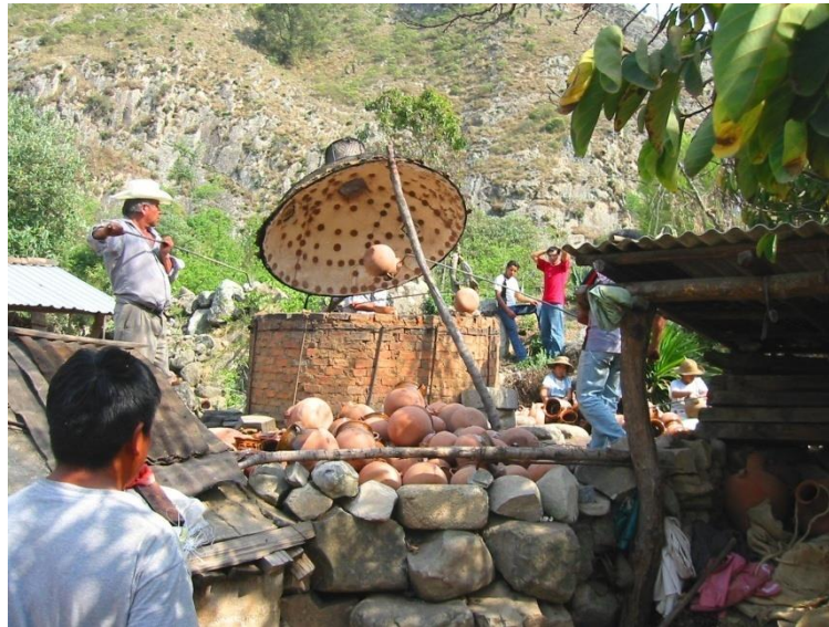
Imagen 10. Quema en Santa Cruz, Zautla, Puebla. Aquí se puede observar la dificultad para extraer las ollas. La operación se realiza con largas varillas para evitar el excesivo calor y para evitar que se peguen ya que el vidriado aún está líquido; además, las ollas no se vidrian completamente. (Fotografía Juan Oliveras y A.)
