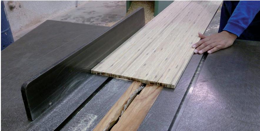
**Imagen 102.** Corte de tablero de bambú laminado con Sierra Circular de Mesa.
