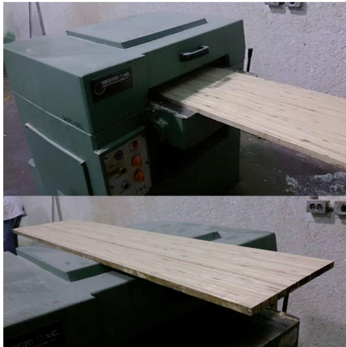
El comportamiento del tablero al cepillado se dificulta cuando se realiza de forma transversal a las fibras, principalmente en las uniones entre reglillas, por lo que se califica como “Malo” esta forma de cepillado. (Imagen 107)
