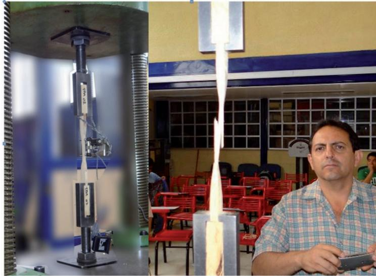
La falla en las probetas se presentó en la zona central debida al esfuerzo normal a tensión inducido en esta zona, la cual se presenta de manera súbita con una deformación muy pequeña antes de que esta ocurra. El esfuerzo normal a tensión promedio para las probetas OLLTAA y OLLTAM fue de  $1,058.51 \text{ kg/cm}^2$  con desviación estándar de  $481.72 \text{ kg/cm}^2$ . (Imagen 84 y 85)
