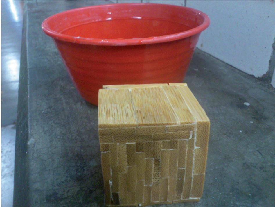
Sin embargo, después de retirarlas del agua, se les comenzó a formar hongos, ya que no tenían ningún recubrimiento. Así mismo, el material se hincho ligeramente debido a la absorción de agua. (Imagen 121)
