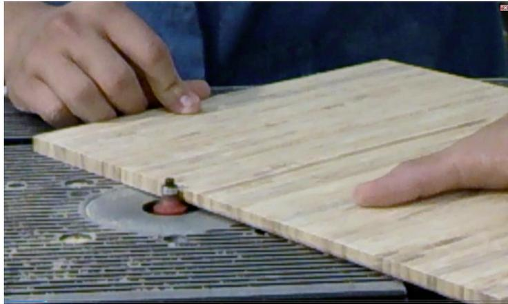
**Imagen 110.** Respuesta al maquinado con router en dirección a las fibras.
