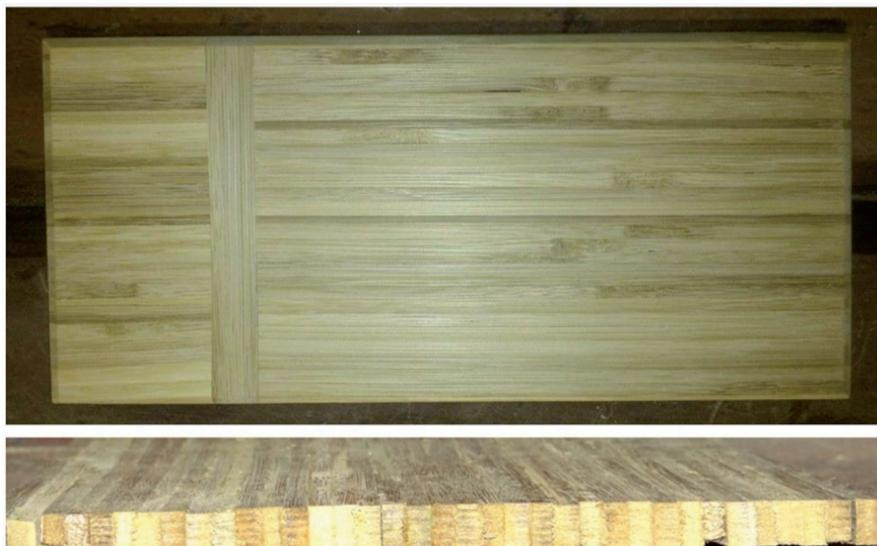
c) Unión por canto. (Imagen 39) Las reglillas se unen por la parte más larga y delgada de la reglilla. Se utiliza un adhesivo, presión y en su caso, temperatura y humedad.
