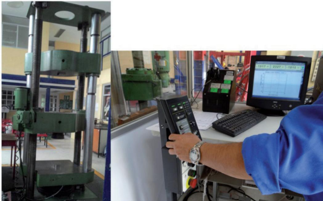
Durante los ensayos se registró la carga aplicada y las deformaciones correspondientes, así como el comportamiento mecánico del material. Para cada ensayo se determina la resistencia a la falla correspondiente. La humedad de las probetas se situó en el rango de 14% a 16%.
