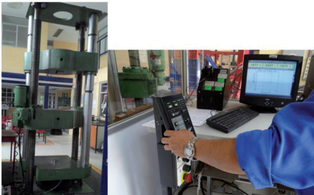
Durante los ensayos se registró la carga aplicada y las deformaciones correspondientes, así como el comportamiento mecánico del material. Para cada ensayo se determina la resistencia a la falla correspondiente. La humedad de las probetas se situó en el rango de 14% a 16%.
