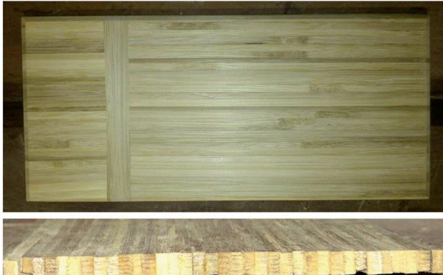
c) Unión por canto. (Imagen 39) Las reglillas se unen por la parte más larga y delgada de la reglilla. Se utiliza un adhesivo, presión y en su caso, temperatura y humedad.
