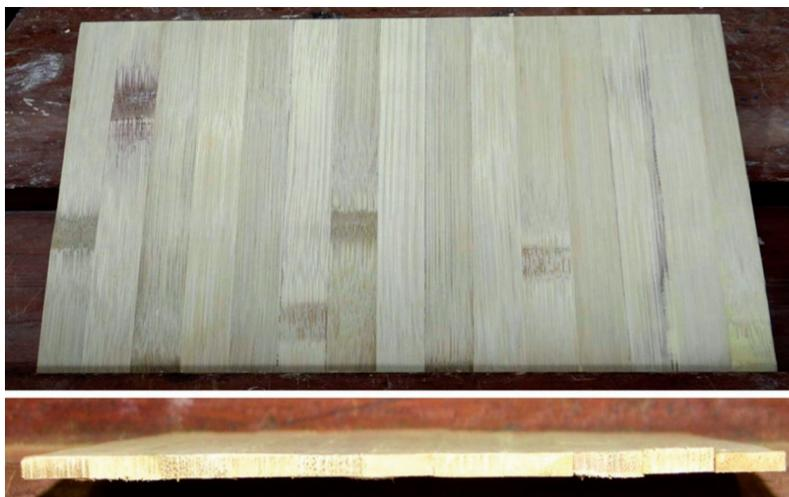
d) Unión transversal. (Imagen 40) Este tipo de tablero se conforma con dos o más laminados dispuestos de forma transversal uno con otro, lo cual proporciona al tablero mayor resistencia que las otras uniones. (Imagen 41) Generalmente unidos con resinas sintéticas mediante presión y calor.
