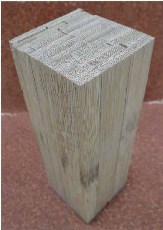
**Imagen 80.** Probetas para Ensayo de Cortante Directo.
