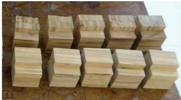
**Imagen 98.** Geometría y esquema de ensaye de probetas OLLVMA.
