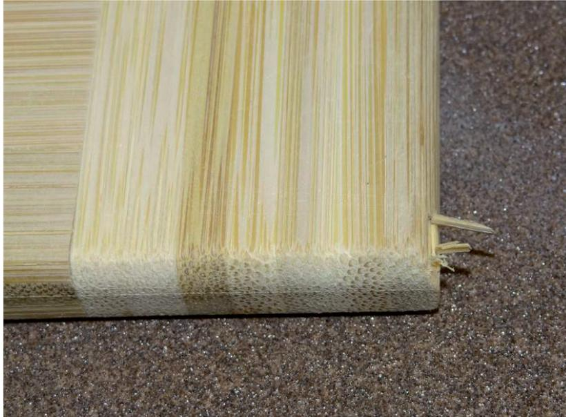
**Imagen 112.** Desprendimiento de fibras en corte 45° con Router.
