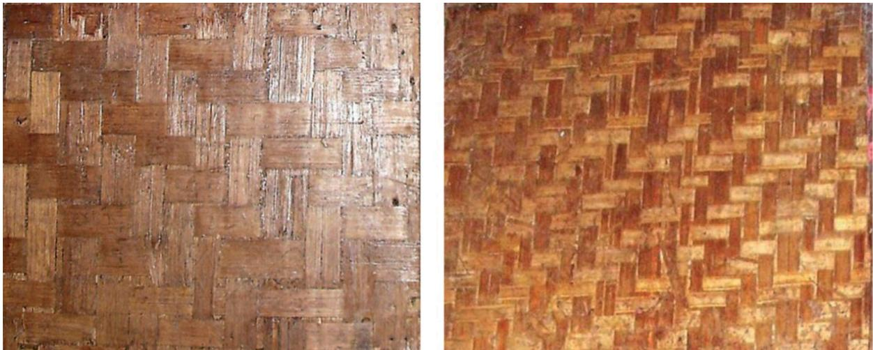
b) Unión por cara. (Imagen 38) En este caso la unión de las regillas se realiza por la cara o la parte más ancha de esta. Generalmente se utiliza un agente químico no contaminante para realizar esta unión, y dependiendo del adhesivo utilizado tam-
