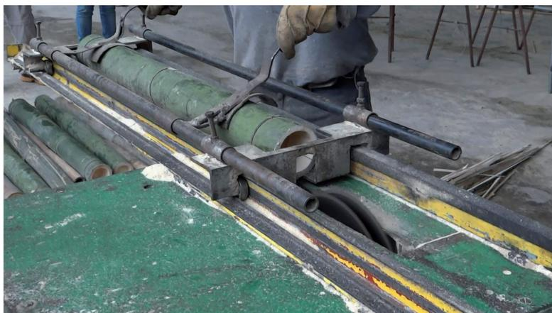
**Imagen 51.** Corte longitudinal con Sierra de Estrella o Cortadora de Cuchillas Radiales.
