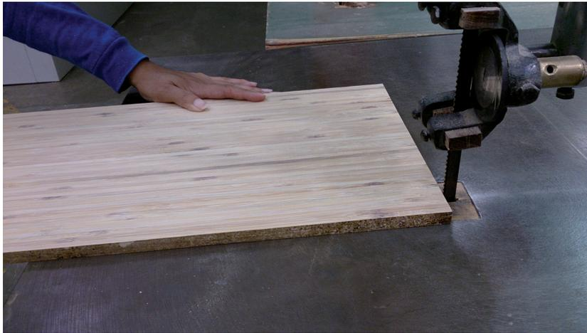
**Imagen 103.** Corte de tablero de bambú laminado con Sierra Cinta.
