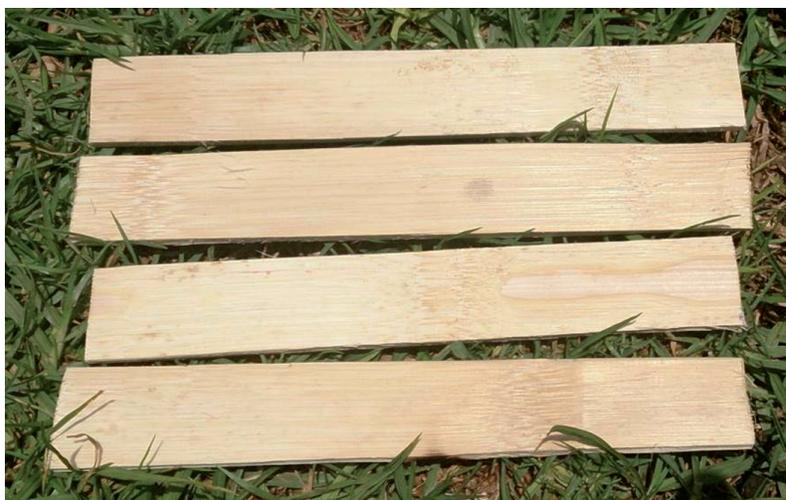
b) Carbonizado. Se realiza utilizando una autoclave donde se introducen las tablillas con vapor de agua a 150°C durante 30 minutos. Este tratamiento modifica la tonalidad de las tablillas a un ámbar oscuro. Al igual que con el tratamiento anterior, se ablandan las fibras.
