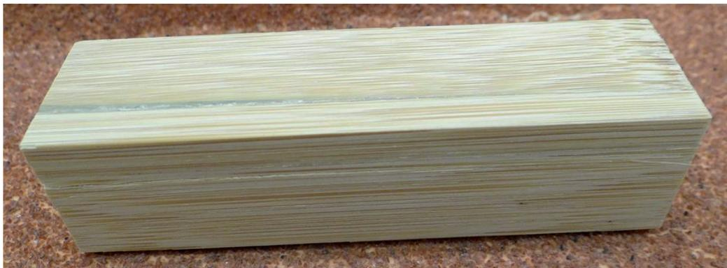
e) Probeta para ensayo de compresión perpendicular a la fibra. (Imagen 79)
