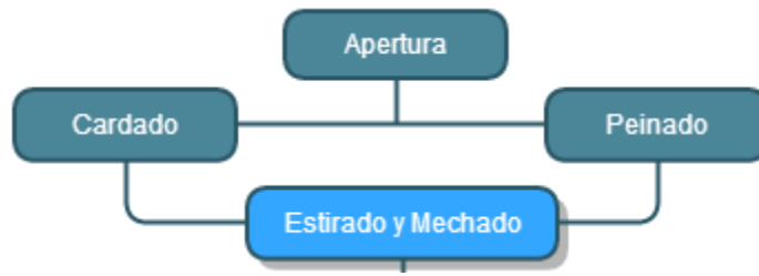
Construcción del proceso de trabajo general: Estirado y mechado.
