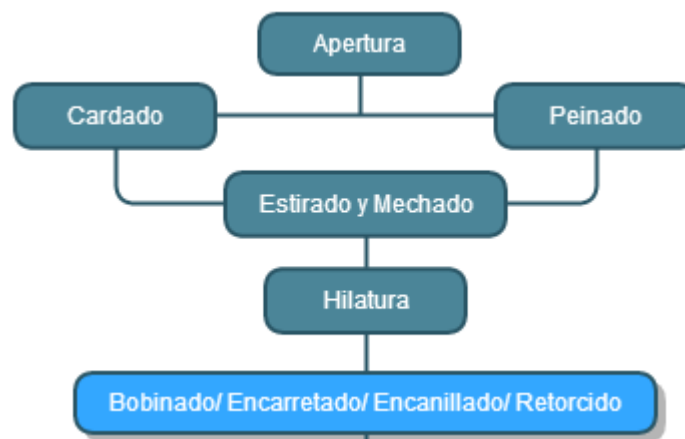
Construcción del proceso de trabajo general: Bobinado, Encarretado, encanillado o retorcido.
