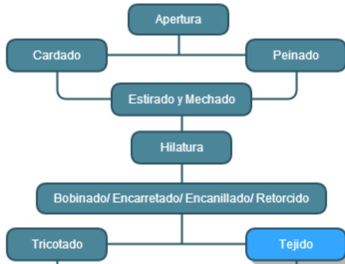
Construcción del proceso de trabajo general: Tejido.
