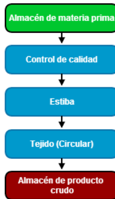
Diagrama de Flujo del Proceso de Trabajo Tejido (Circular) Empresa Textil, 2014
