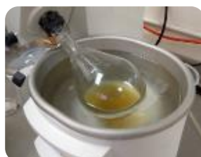
Figura 7. Rota-evaporación de extractos de ricino
