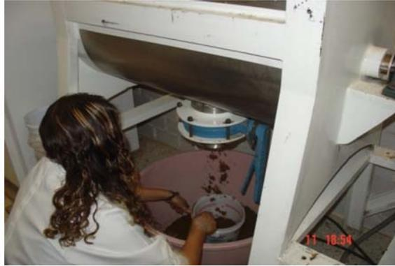
**Ilustración 5. Incorporación del rastrojo y empaque de los bloques**
