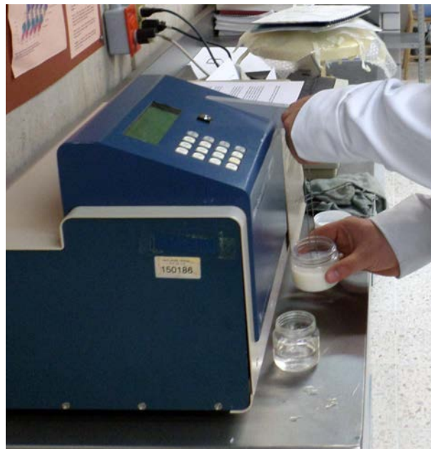
Figura 26. Determinación de grasa y proteína láctea mediante MilkoScan 133B
