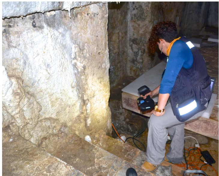
Figura 15. Levantamiento con escáner de luz estructurada en la Tumba de Pakal. Fuente: Laboratorio 3D CNCPC-INAH, 2017.
